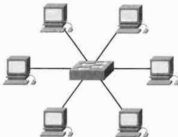
Рис. 5.16. Сегментация с помощью коммутаторов
