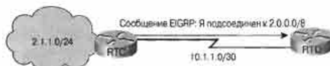
Рис. 4.14. Автоматическое обобщение маршрутов протокола EIGRP
