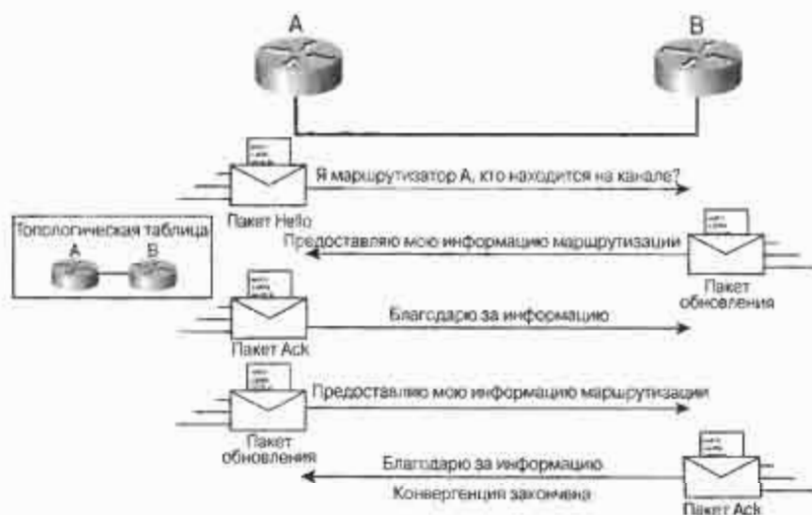
Рис. 4.5. Соседние устройства протокола EIGRP обмениваются информацией о маршрутах
