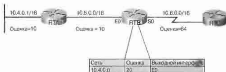
Рис. 3.14. Выбор протоколом OSPF наилучшего маршрута
