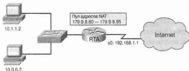
Рис. 11.12. Пример работы адресации PAT
