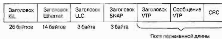
Рис. 10.8. Инкапсуляция сообщений протокола VTP во фрейм протокола ISL
