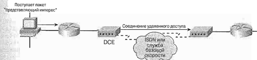
Рис. 14.14. Общий характер функционирования маршрутизации DDR
