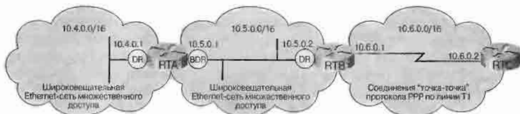
Рис. 3.13. Выбор маршрутизаторов DR и BDR в сети протокола OSPF
