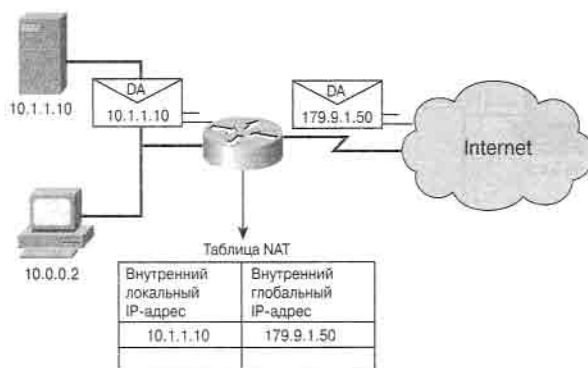
Рис. 11.9. Статическая NAT-адресация
