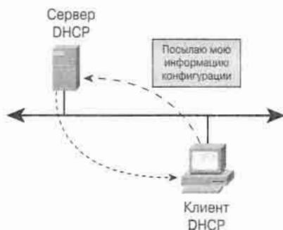
Рис. 11.17. Клиент и сервер протокола DHCP
