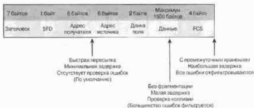
Рис. 7.11. Заголовок фрейма
