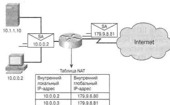
Рис. 11.10. Динамическая NAT-адресация
