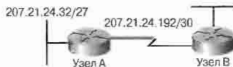
Рис. 2.5. Использование маски VLSM для адресации соединения типа “точка-точка”
