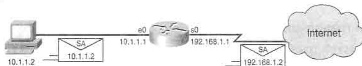
Рис. 11.11. Пример статической адресации NAT
