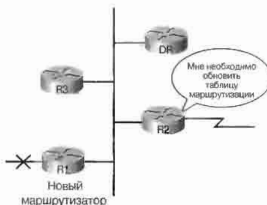
Рис. 3.15. Информация о состоянии канала протокола OSPF
