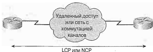
Рис. 13.8. Согласование параметров канала PPP
