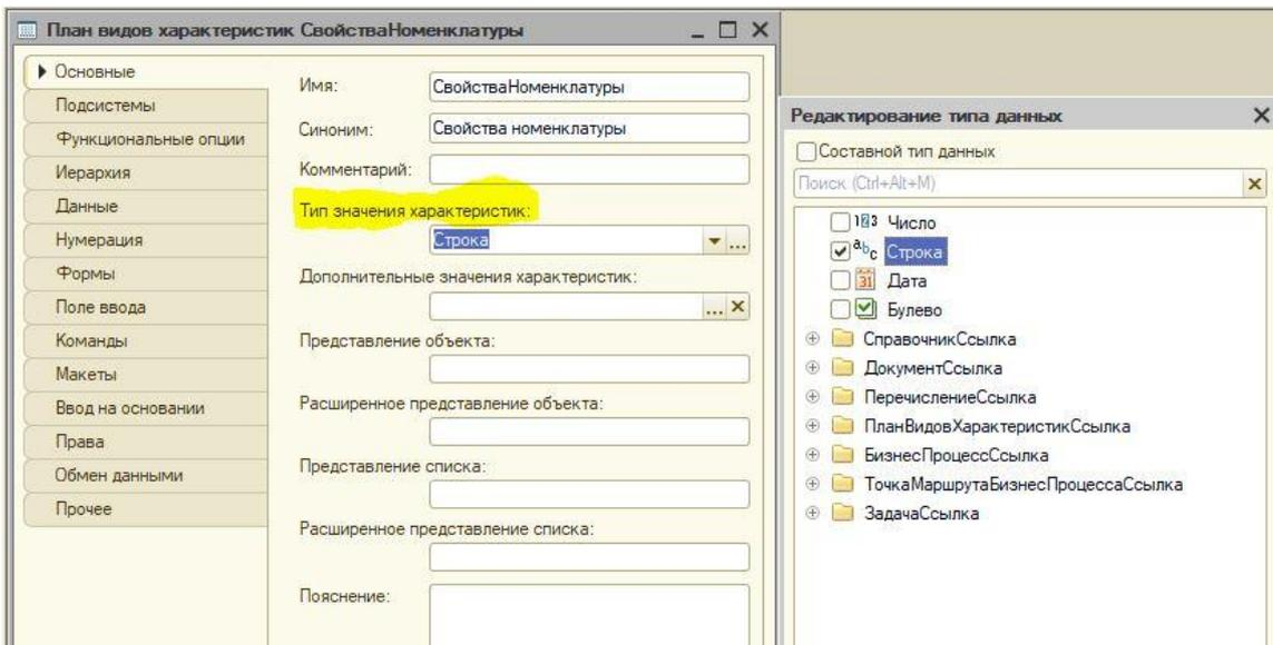
Для предоставления пользователю возможности дополнительного создания характеристик, нужно создать справочник, Владелец установить созданный план видов характеристик и указать этот справочник в Дополнительных значениях характеристик.
